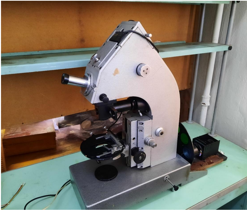
Рис. 2.7. Загальний вигляд мікроскопу МБІ-6, модернізованого камерою.
