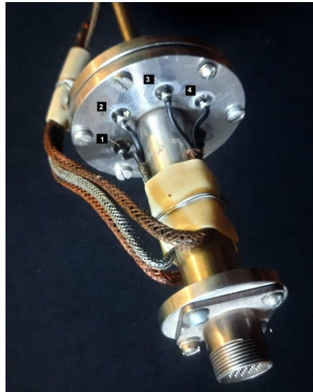
Рис. 2.4. Інтерфейсний роз'єм (верхня частина стрижня вставки).
