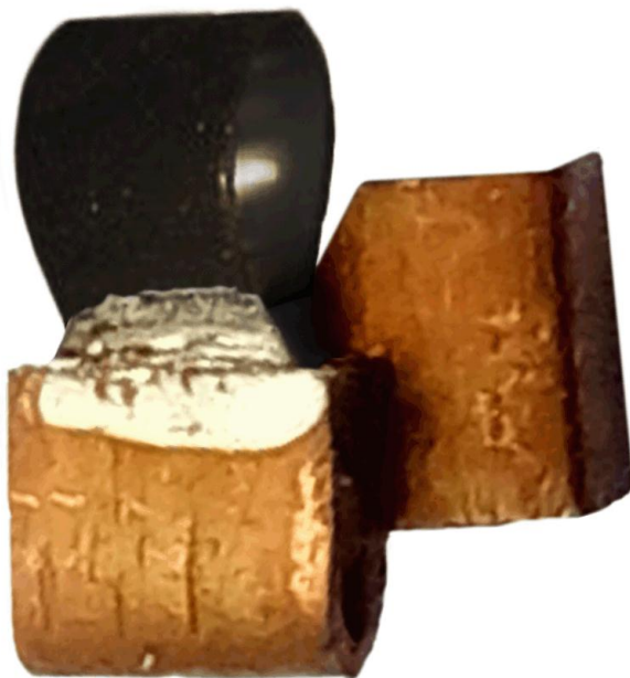
Рис. 4.2. Зовнішній вигляд електрода SWNT, який закріплений у мідному тримачі за допомогою срібної провідної пасти.
