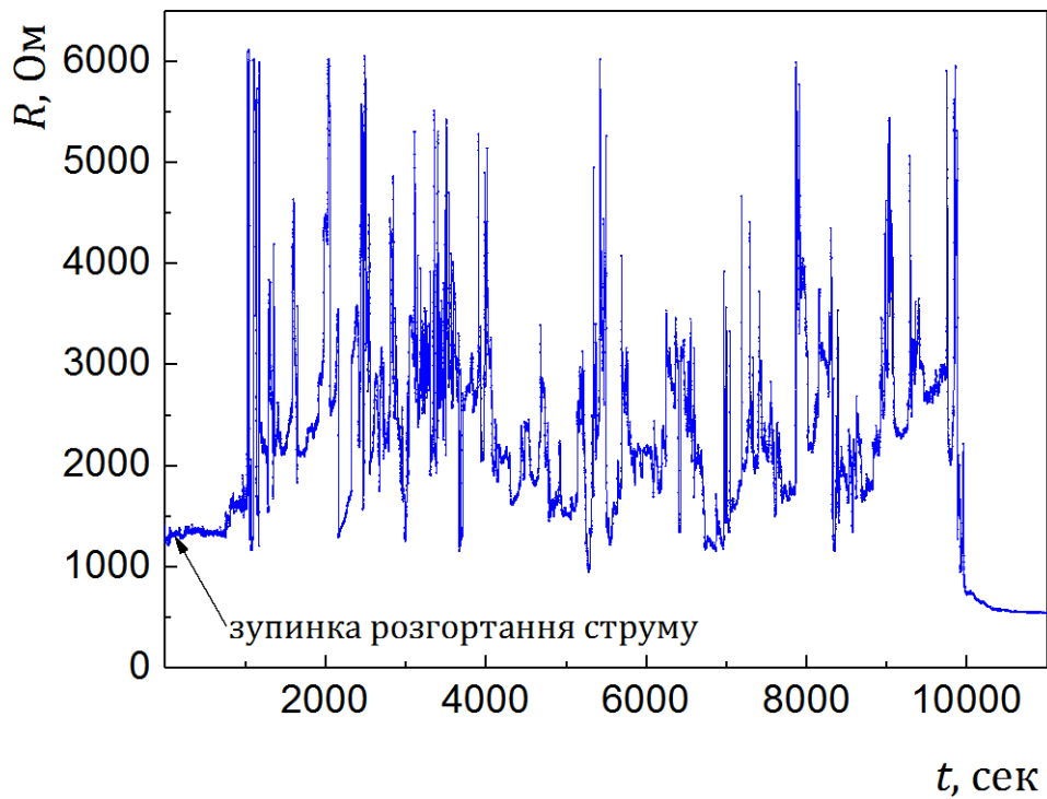
Рис. 5.2.5 б. Залежність опору R точково-контактної структури від часу t , що демонструє циклічні зміни електропровідності при постійному струмі.
