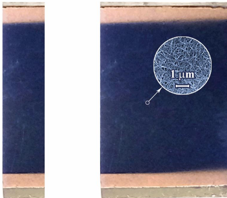
Рис. 4.1. Фотографія смужки нафіону з нанесеною плівкою одностінних ВНТ. На вставці наведено зображення верхнього шару одностінних ВНТ, що напилені на мембрану з нафіону, яке отримано за допомогою скануючого електронного мікроскопа.
