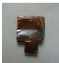
Рис. 2.3. Двокомпонентна плівка-підкладка на мідному каркасі.
