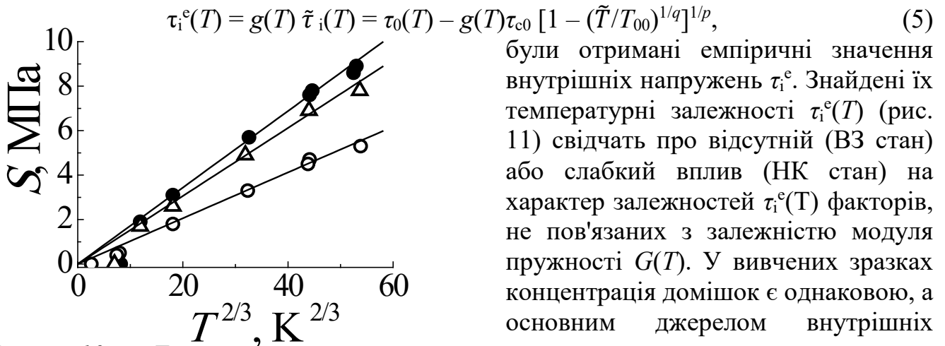
Рис. 10. Температурні залежності швидкісної чутливості межі плинності (див. рис.2) в координатах [(\Delta\tilde{\tau}/\Delta\ln\dot{\gamma})_T - \tilde{T}^{2/3}] .
